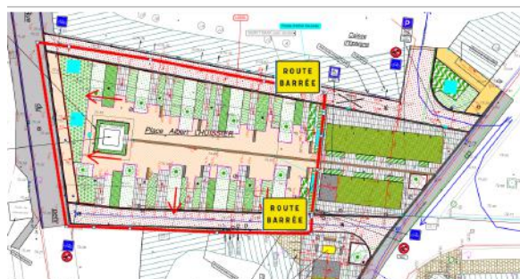
Phase 4 : 1ère 15aine de Novembre Travaux de bordures : - Côté pharmacie - Rue du petit train
